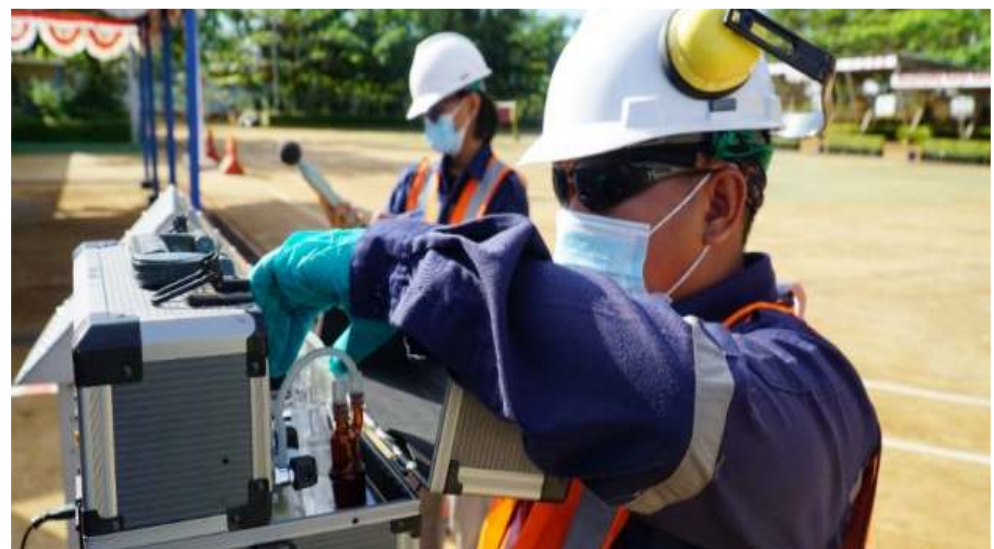
Pemantauan Emisi Udara oleh Teknisi dari Laboratorium Terakreditasi
