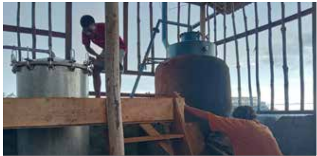
Proses destilasi tanaman kayu putih yang berasal dari lahan reklamasi The distillation process of eucalyptus plants sourced from reclamation land.
